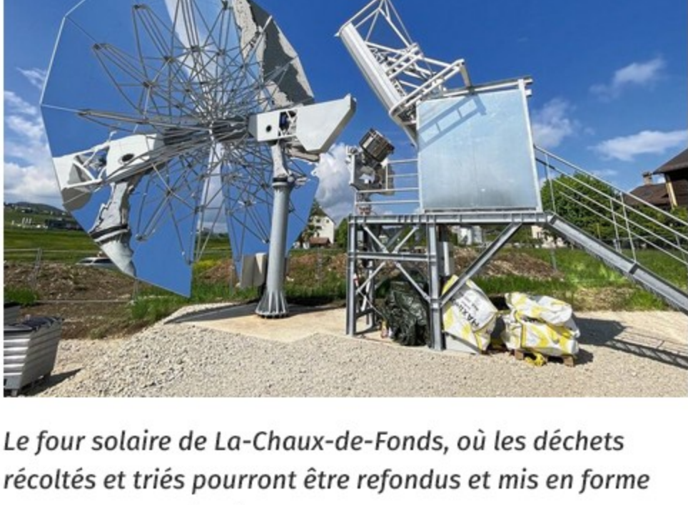
Le four solaire de La-Chaux-de-Fonds, où les déchets récoltés et triés pourront être refondus et mis en forme pour une seconde vie. (Source : Panatere)
